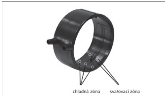
Obrázek 913 Spojka Akasison se svařovacími a chladnými zónami
