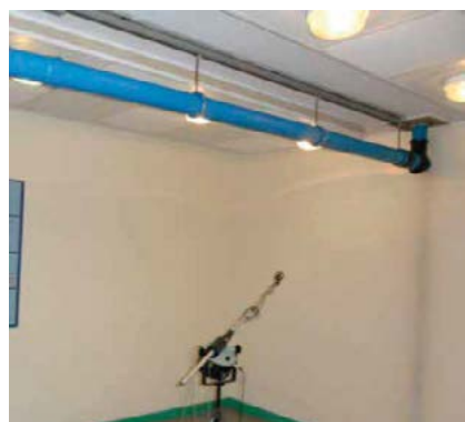
Fot. 6 Měření přímého hluku
